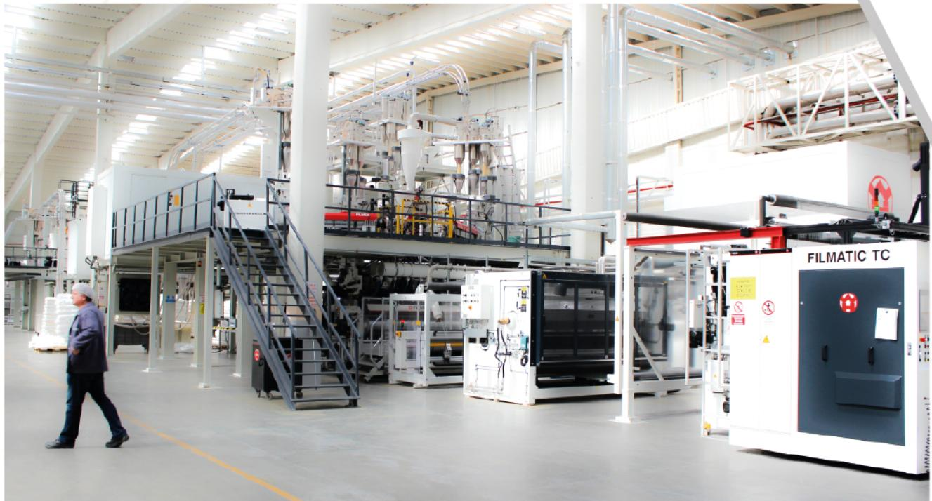
8000 m<sup>2</sup> lik kapalı alana sahip Cast Film Bölümünde 5 Katlı CPP Film(400 Ton/Ay) ve 33 Katlı Nano Teknoloji ile Streç Film(1500 Ton/Ay) Üretilmektedir.
